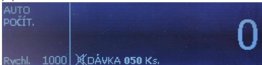
2. Přidržením tlačítka BATCH na déle než 3 sekundy dojde k přepnutí na manuální nastavení dávky. Nastavení požadované dávky lze provést editací podtržené číslice navigačními tlačítky (šipka dolů a šipka nahoru), k posunu na další číslici dojde stlačením tlačítka SET. K uložení dávky a opuštění manuálního režimu nastavení dávky dojde po stisknutí tlačítka BATCH.
